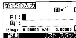
P1 を入力して【ENT】を押した後、角 1 または【点入力】キーで 2 点目を入力して直線を規定します。
