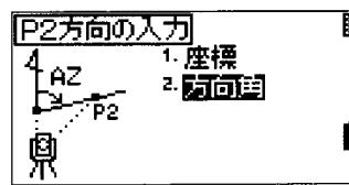
【2】の方向角入力を選択すると、右図のように角度の入力画面が表示されます。方向角を入力し、【ENT】キーを押します。
