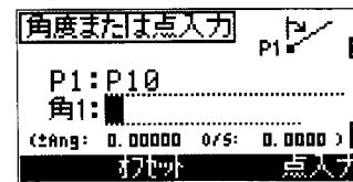
1 点目と同じ要領で、2 点目を P2 に入力します。点名を手入力する代わりに【観測】キーで、その場観測した点を計算に使用することもできます。
