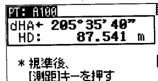
dHA : 現在望遠鏡が向いている方向から、測設点方向までの誤差角 ( $0^{\circ} 00' 00''$  が測設点方向)
