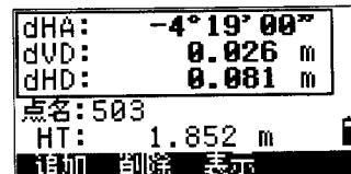
【削除】キーを押すと、選択されているデータの削除確認画面が表示されます。【はい】キーで削除が実行されます。
