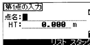
1 点目を視準し、【測距 1】または【測距 2】キーを押します。(必ず測距が必要です)
