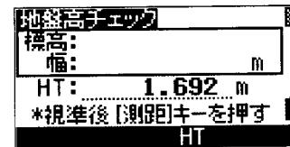
途中、測標高(HT)を変更するには、画面下の[HT]表示に対応するキーを押します。HT欄にカーソルが入り、数値入力できます。【スタッツ】キーで、以前に入力した測標高の値を呼び出して入力することも可能です。(測標高の【スタッツ】入力につきましてはp.3-26をご参照下さい。)
