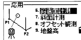
鉛直面を規定するため、鉛直面上の 2 点を入力します。
