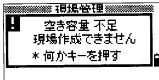
新規現場を作成しようとしたとき、現場を作成するための空き容量が少ない場合に表示されます。
