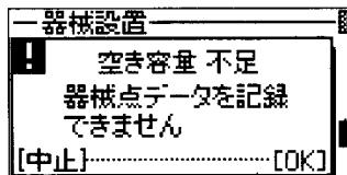
器械設置の既知点設置、任意点設置を選択したとき、データを記録するための空き容量が少ない場合に表示されます。
