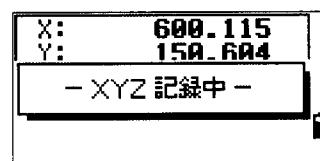
記録後、測設観測画面に戻ります。【ESC】キーを押すと「距離、高さ、角度」の入力画面に戻り、次点観測に続けます。
