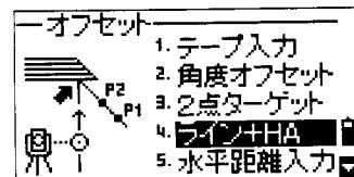
下図のように、測距する2点(P1、P2)は、座標を求めたい求点(図では軒下の点)と一直線上になるようにします。
