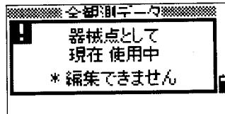
編集しようとした角度距離データが、現在使用中の器械点データ (ST レコード) だった場合に表示されます。
