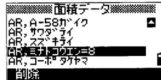
面積や周辺長データを確認したい行にカーソルを移動させ、【ENT】を押します。すると、詳細データが表示されます。
