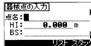
後視点名を入力して【ENT】キーを押すと、次に、観測した後視点の測標高（HT）を入力します。点名欄には、一つ前の画面で入力した後視点名が予め表示されていますから、測標高を入力して【ENT】キーを押せば、器械点及び視準点が記録されます。
