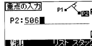
P2 を入力して【ENT】を押すと、垂線の足の座標を計算して結果を表示します。P1、P2 両方に Z 座標があれば、計算結果の Z 座標は P1-P2 の勾配に比例して算出されます。
