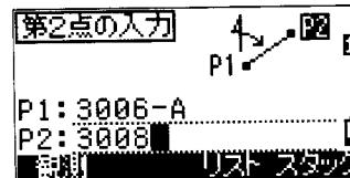
1 点目から 2 点目への方向角、水平距離、高低差が表示されます。
