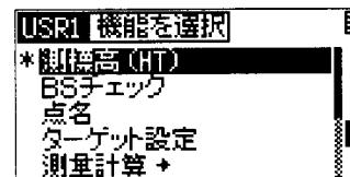
【▲】【▼】キーでカーソルを移動し、【ENT】キーを押して、割り付ける機能を選択します。
