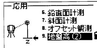
現在、本機上に設定されている器械高(HI)、器械点の標高と、ターゲット側の測標高(HT)が表示されます。変更があればキー入力し、【ENT】キーを押します。
