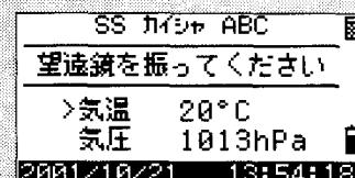
望遠鏡を振る前に、本体を回転すると、水平角の初期化が行われ、右の画面が表示されます。（水平目盛りの〇位置が設定されます）
