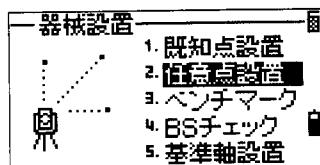
「任意点設置」では、座標が既知の2点を観測します。まず、第1点目の観測点名と、測標高(HT)を入力し、
