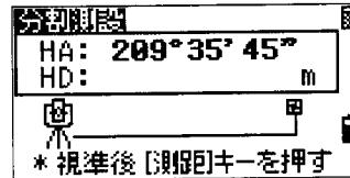
水平距離が表示されるので、この水平距離に対する分割数を入力します。
