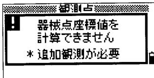
任意点設置で、観測したデータの削除を行い、器械点座標値が計算できない条件となった場合に表示されます。
