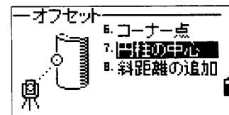
円柱表面上の1点を視準し、【測距1】または【測距2】キーを押します。
