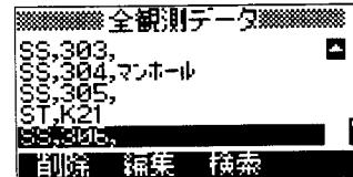
カーソルキーを用いて、詳細データを見たいデータ行に反転カーソルを移動させ、【ENT】キーを押します。詳細画面が表示されます。
