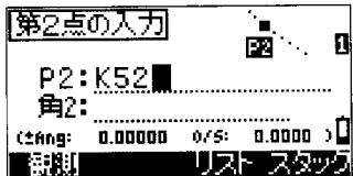
入力した P2 を通る直線を規定します。角 2 に方向角を入力するか、または【点入力】キーで一本目の直線を通るもう一つの点名を入力します。オプションとして【オセット】キーで規定した直線に、さらに角度や距離のオフセットを加えることも可能です。（【点入力】【オセット】の詳細は、p.3-127 をご参照下さい。）
