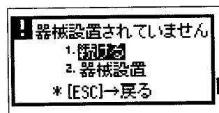
器械設置が必要な機能を選択したとき、器械設置が完了していない場合に表示されます。
