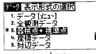
カーソルを「4.座標データ」に移動して【ENT】キーを押すか、数字キーで【4】を押すと、座標データが表示されます。これで設定完了です。【ESC】キーを押すと、元の観測画面へ戻ります。
