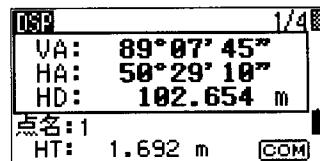
[COM] マークが表示された基本観測画面で【ENT】キーを押すと、観測データは通信ポートから外部出力されます。
