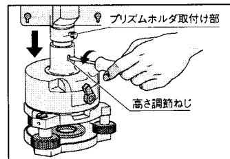
**注意** • NST-305/305C を使用する場合は、プリズムホルダ取付け部を下げた位置にして下さい。
