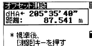
3 測距後、観測点と測設点の誤差が表示されます。
