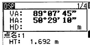
測距中は「————」または「))))」が走り、測距中を示します。また、設定されているプリズム定数が、バー表示の下に<30mm>の様に表示されます。(次頁参照)
