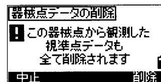
画面下の【削除】キーを押すと、選択した器械点データ及び、付随する全視準点データが削除されます。
