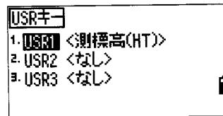
【USR】キーに割り付ける機能一覧が表示されます。現在【USR】キーに割り付けられている機能の先頭には、「\*」マークが表示されています。
