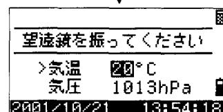
望遠鏡を正の観測状態にして、上下に振って下さい。（望遠鏡を振ることにより、高度目盛りの〇位置が設定されます。）
